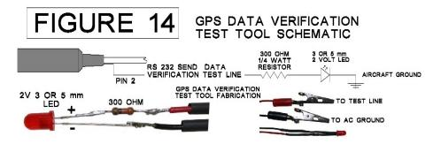
4.) CONNECT THE TEST TOOL AS SHOWN IN FIG 14. THE MAIN SWITCH ON THE ELT SHOULD BE IN THE "<u>ARMED</u>" POSITION.
